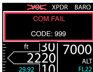
Abbildung 10.4: Das angeschlossene COMM-System hat einen fatalen Ausfall erkannt; der Fehlercode wird angezeigt. Nicht betroffene Systeme bleiben funktionsfähig.
